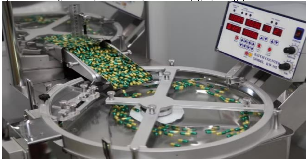
Dây chuyền sản xuất thuốc viên nang mềm. Ảnh: Etek
